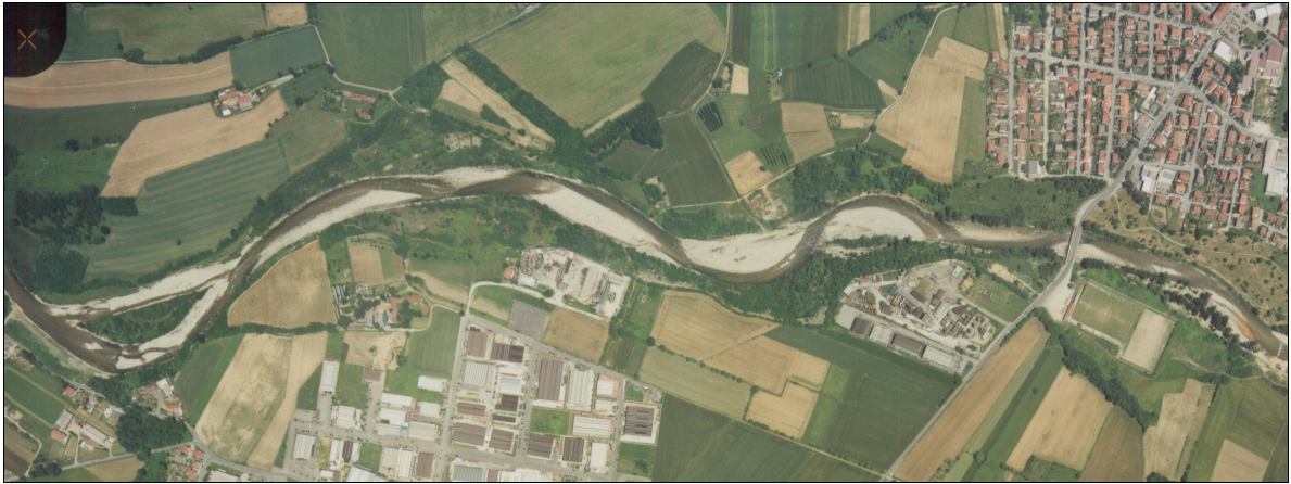
Foto 11 – Torrente Sangone – Tracce dell’evento dell’ottobre 2000 nel tratto C-D. Situazione dalla curva al confine con Bruino dove si vede l’alveo sussidiario aperto nel 1996 al ponte di Via Piosasco con le profonde lunate nel luogo della savanella aperta dopo la piena del 1981. Si osservi che le nuove erosioni sono all’interno di ben più profonde lunate apertesi nel 1981 (in destra) e in epoca ancora anteriore (in sinistra) (ripresa aerea del 2002)
